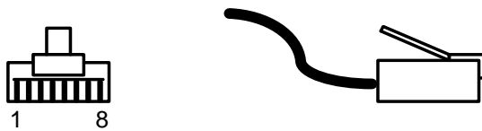
а) вид и нумерация контактов разъема RJ45
